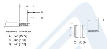
1. SLIDE CLAMP NUT ①, THINNER WASHER ② & GASKET ③ OVER CABLE. STRIP CABLE AS SHOWN. DO NOT NICK BRAID WHILE CUTTING JACKET. TAPER END OF BRAID TO PERMIT ASSEMBLY OF CLAMP.
